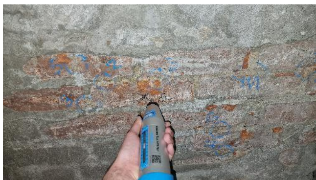
FIGURA 12 – SCLEROMETRIE CĂRĂMIZI
