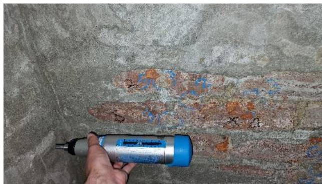
FIGURA 13 – SCLEROMETRIE CĂRĂMIZI
