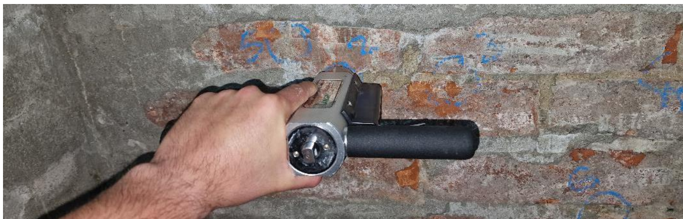
FIGURA 10 – PENETROMETRIE MORTAR
