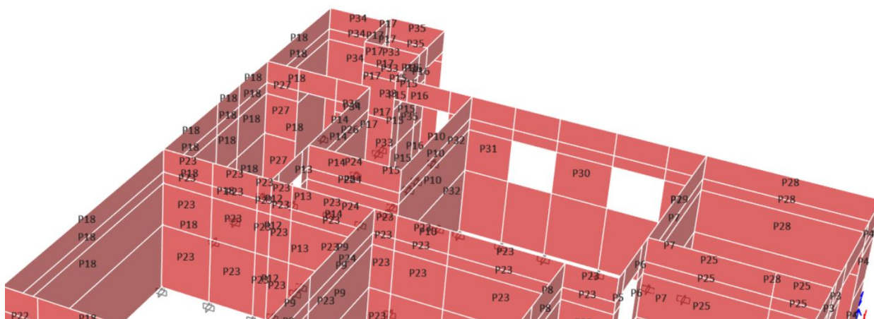
FIGURA 34 – IDENTIFICAREA ETICHETELOR (PIER) PE MODELUL 3D, LA PARTER
