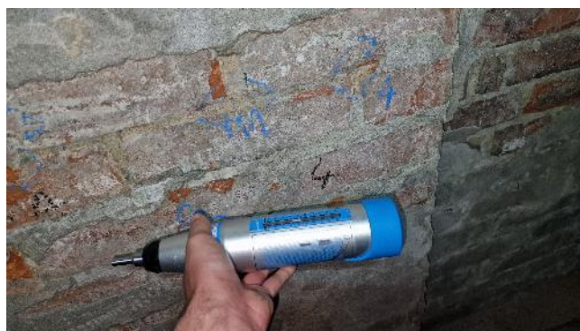
FIGURA 12 – SCLEROMETRIE CĂRĂMIZI
