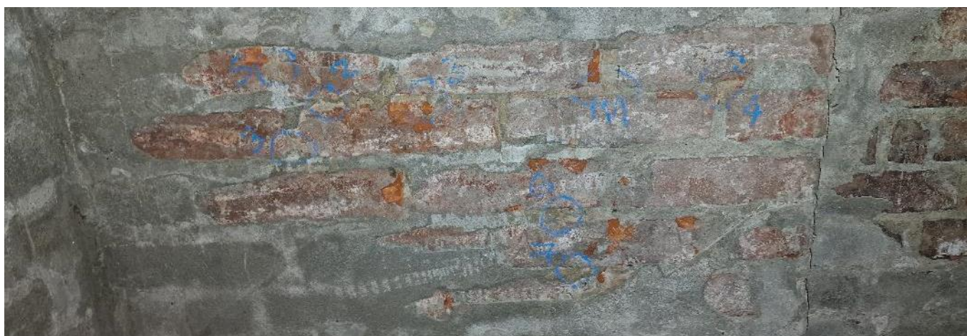
FIGURA 11 – POZIȚII ÎNCERCĂRI PENETROMETRIE ȘI SCLEROMETRIE
