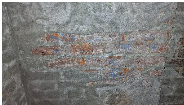
FIGURA 13 – SCLEROMETRIE CĂRĂMIZI
